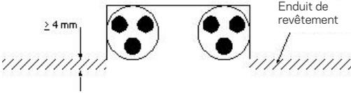
(\*) Dans du béton : 3 cm min.
