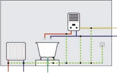
Tous les éléments conducteurs étrangers (baignoire, tube de douche...) et les masses du matériel électrique à basse tension et très basse tension doivent être reliés localement aux conducteurs de protection des circuits aboutissant dans la salle d'eau.
